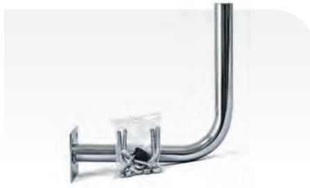
Pinces pour la station de référence EPOS™. Dimensions: 300 x 250 mm, diamètre 32 mm. Pour les murs ou les poteaux de 30 à 60 mm. Acier.
